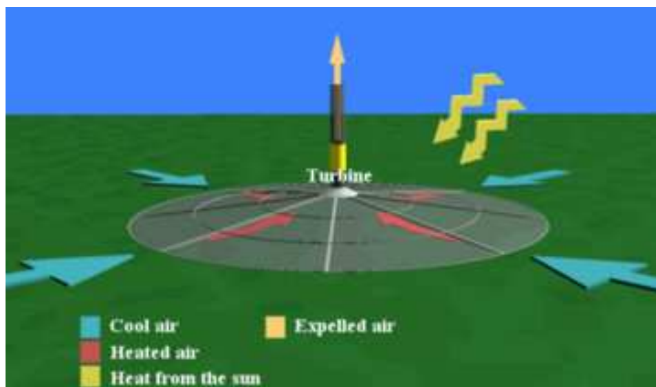
Figura 2.1: Principio di funzionamento.
